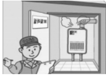
보일러실 배기통 점검
