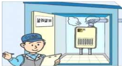
보일러실 배기통 점검
