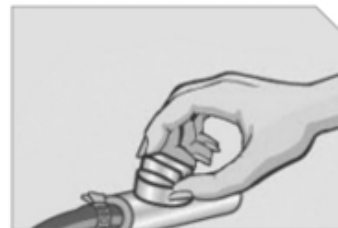
보일러실 배기통 점검
